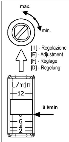
**[I]** - Le valvole di bilanciamento sono dispositivi idraulici che consentono di regolare la portata del fluido verso i terminali dell'impianto. Rispettare la direzione del flusso come indicato dalla freccia impressa sul corpo. La valvola può essere installata orizzontale o verticale con qualsiasi senso di flusso. Per una precisa e stabile lettura assicurare un tratto rettilineo di almeno 5 diametri prima del dispositivo.
