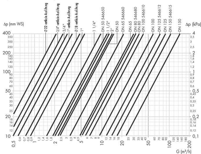
**Die empfohlene Höchstgeschwindigkeit des Mediums an den Anschlüssen des Schlammabscheiders beträgt ~ 1,2 m/s. Die folgende Tabelle zeigt die zur Einhaltung dieser Bedingungen erforderlichen maximalen Durchflusswerte.**
